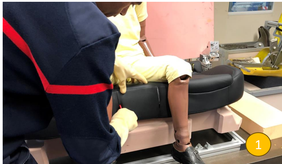
Découpe de la coiffe d'assise au niveau place centrale
