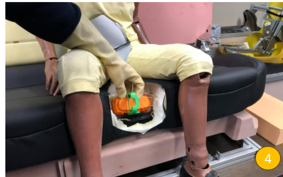
Accès au plug service batterie pour déconnection
