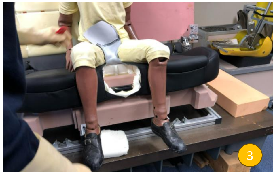
Arrachement de la matelassure d'assise (prédécoupe)
